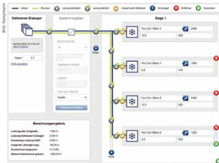
Visuelles Anlagenschema des Rohrnetzrechnungs-Tools: Durch Anklicken der Geräte lassen sich die Rohrleitungen definieren.
